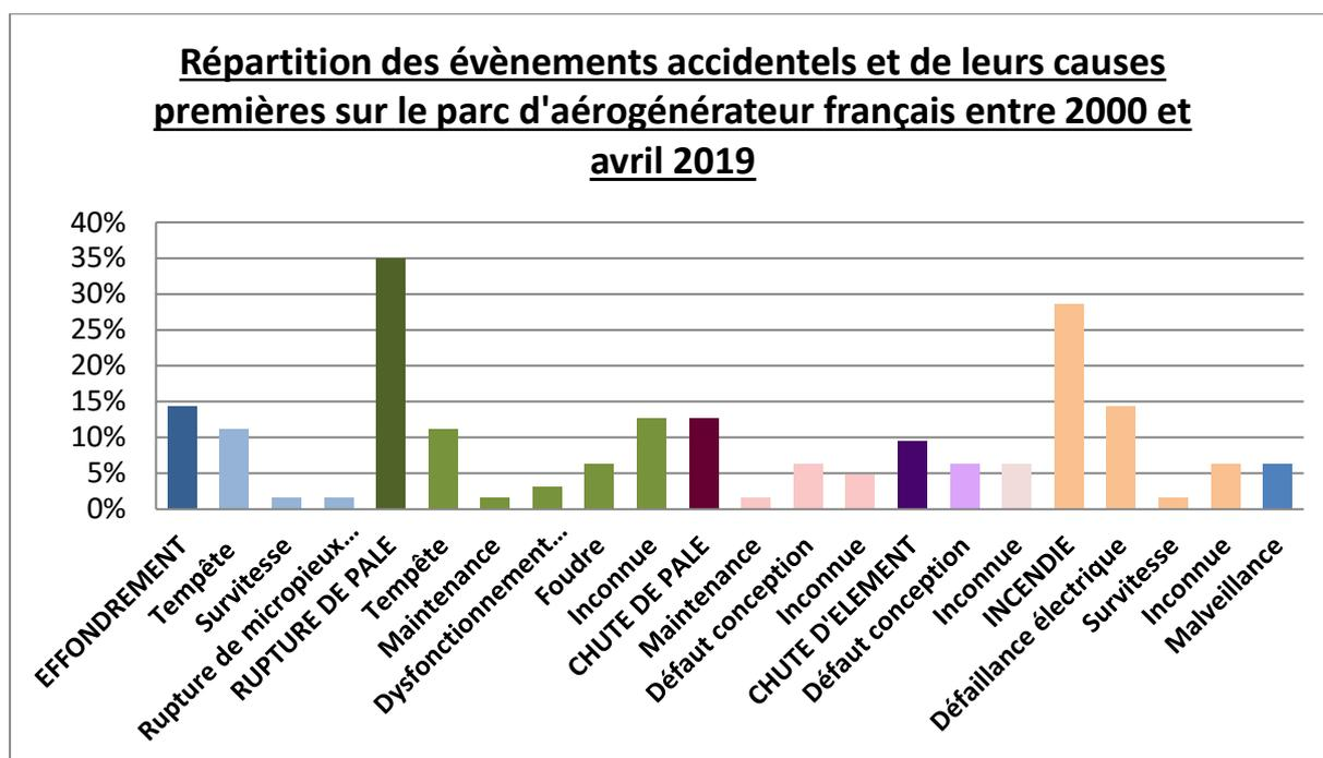
Par ordre d'importance, les accidents les plus recensés sont les ruptures de pale, les incendies, les effondrements, les chutes de pale et les chutes des autres éléments de l'éolienne. La principale cause de ces accidents est la défaillance électrique.
