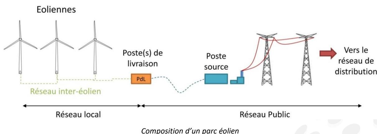
Les machines qui seront implantées sur le site sont de type Nordex N131 ou équivalent. Ces éoliennes ont une hauteur de moyeu d'environ 100,6 m. La hauteur totale en bout de pale sera quant à elle de 165 m.
